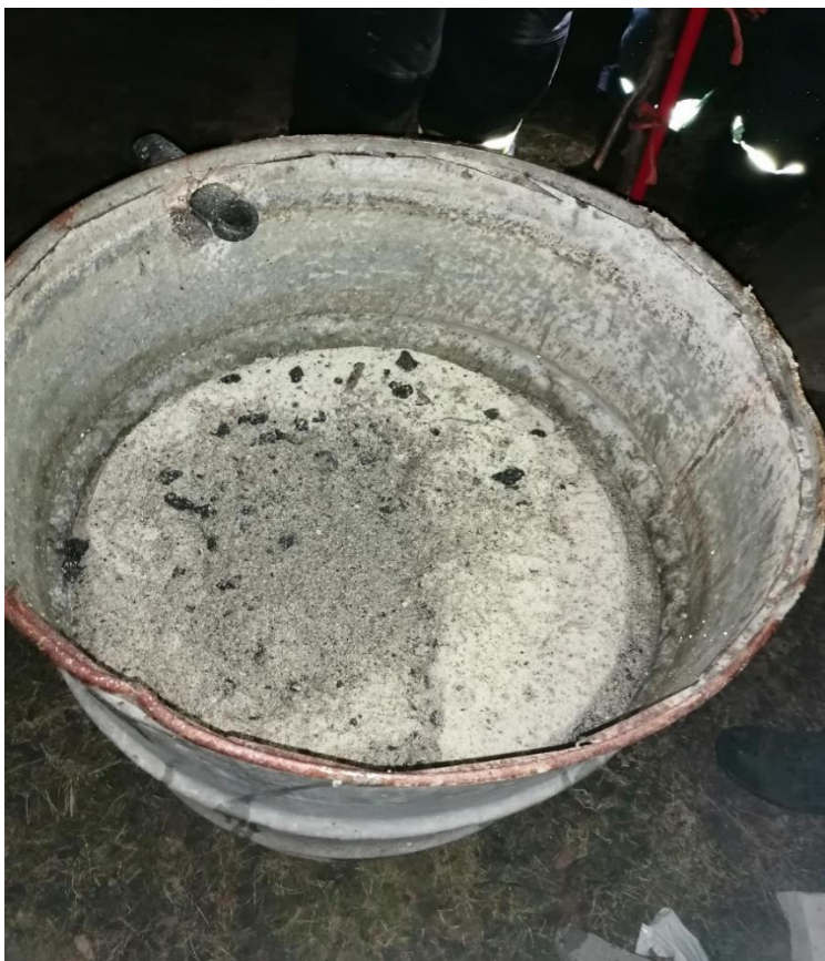
Obr. č. 7 Odstránená fáza ropných látok zo studne
