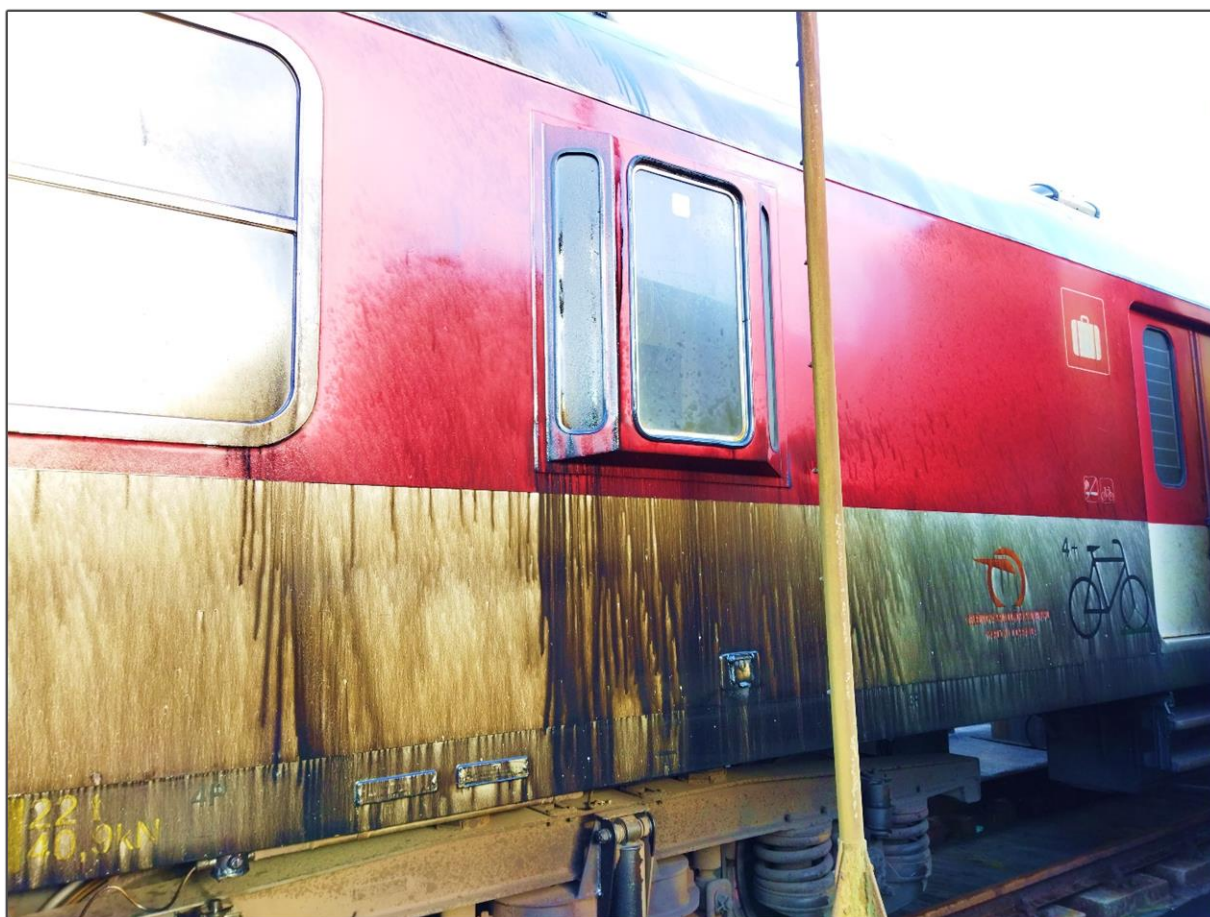
Obr. č. 4 Znečistenie železničného koľajového vozidla motorovým olejom
